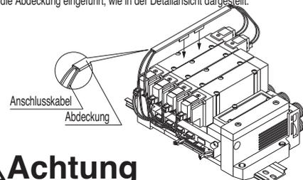
**Erweitern der Mehrfachanschlussplatten (nur Serie SY9000) Erweiterung an jeder Position möglich.**
